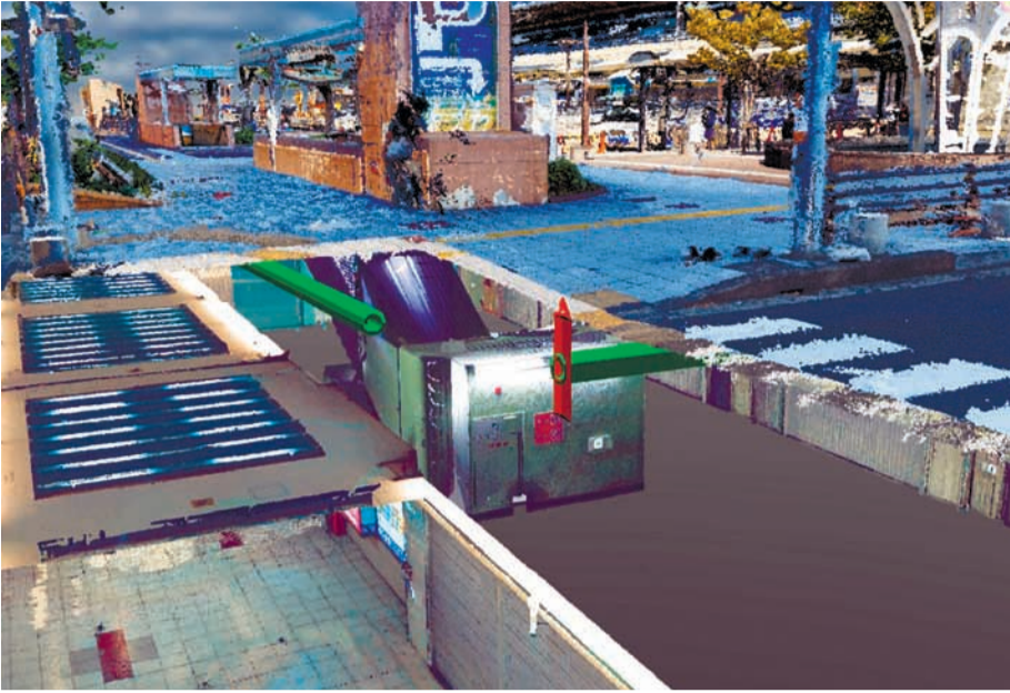
地上から見たエスカ地下街と下水管との位置関係 (中村栄治愛知工業大教授提供)
